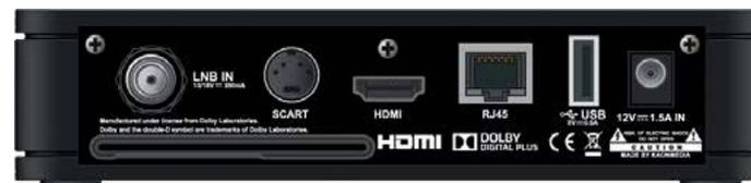
Poznámka: Usporiadanie portov pri Kaon KSTB2096 PVR READY sa odlišuje z dôvodu absencie slotu na dekódovaciu Smart kartu.
