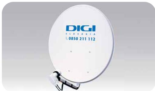
Pri nastavení je potrebné LNB správne natočiť mierne doprava z pohľadu za parabolou (pozri elevačný uhol) a zároveň nastaviť ohnisko paraboly pozdĺžnym posúvaním LNB v príchytke.
