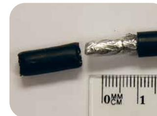
Odstráňte vrchnú izoláciu koaxiálneho kábla. Nepoškodte a neodstraňujte hliníkové tienenie. Hliníkové tienenie prehnite cez vrchnú izoláciu kábla.
